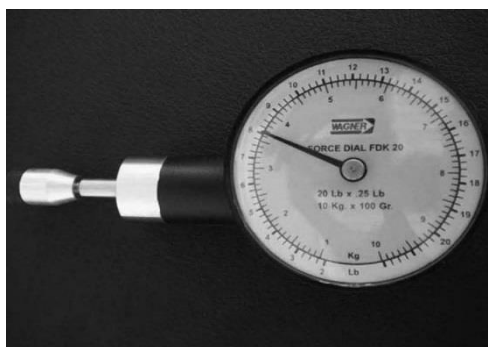
Imagen 19. Algómetro con dispositivo de muelle sencillo. Elaboración propia
